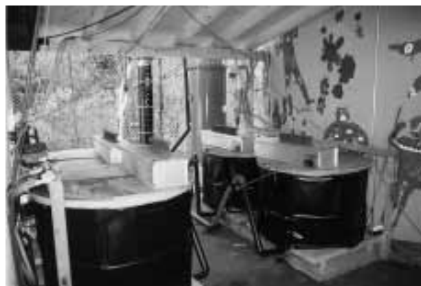
Figure 2: Expérimentation au Mühlbach près de la station de Wartau en 1999. Les bacs à poissons avec les dispositifs de filtration intercalés (colonnes en arrière plan)
